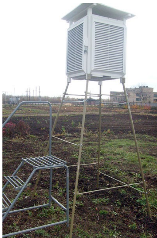
Схема В1. Метеорологическая будка.
